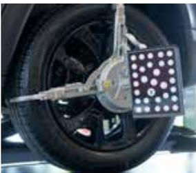
Die Radklammer greift mit begrenzter Spannkraft auf dem Reifen, ohne die Felge zu berühren. So wird jedes Mal ein sicheres, schnelles und gleichmäßiges Klemmergebnis gewährleistet.
